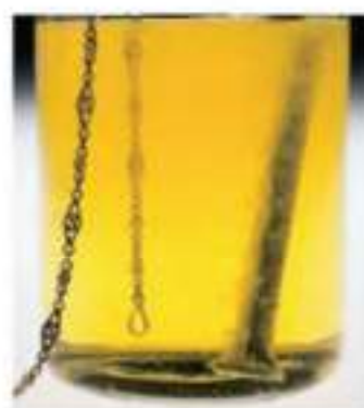
▲ FIGURA 1.3 Una propiedad química del cinc y el oro: reacción con ácido clorhídrico. El clavo cincado (galvanizado) reacciona con ácido clorhídrico produciendo burbujas de gas hidrógeno que se ven en la superficie del clavo. El brazaletes de oro no se afecta por el ácido clorhídrico. En la fotografía, el cinc se ha consumido, quedando el hierro a la vista. La reacción del hierro con el ácido clorhídrico colorea la disolución ácida.
